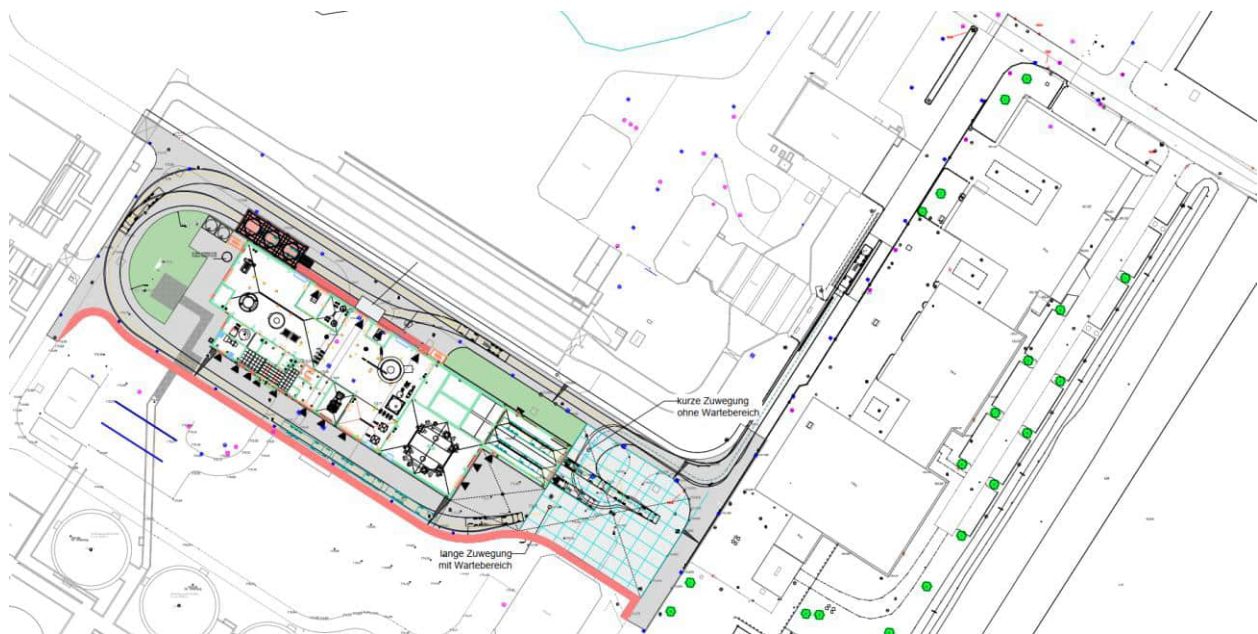
Abbildung 11: Standortlogistik – Andienungswege Haupt-Betriebsmedien KVA
