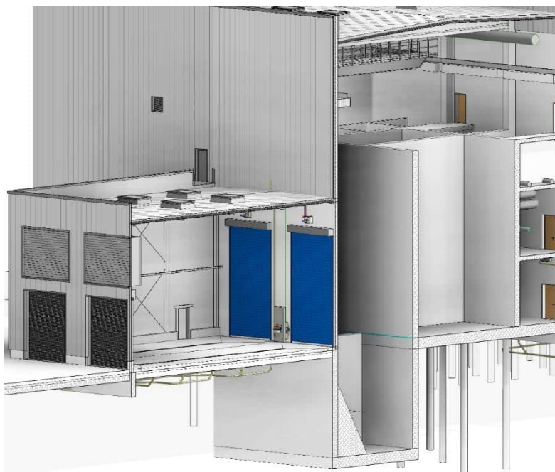
Abbildung 2: Darstellung Annahmebereich und Bunker des Neubaus der KVA
